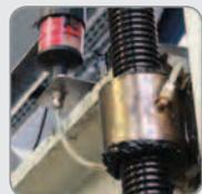
La presión generada de 6 bares permite montaje a distancia de hasta 5 m
